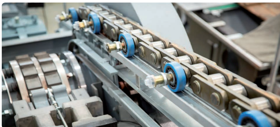
Einblick in den Antriebsmechanismus einer Fahrtrepppe (Quelle: thyssenkrupp)
