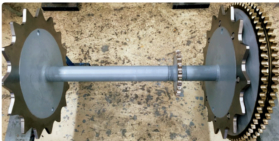
Antriebswelle einer Fahrtrepppe (Quelle: thyssenkrupp)
