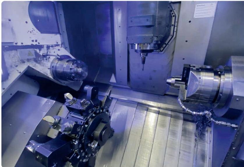
Blick in den Arbeitsraum des Drehfräszentrum CTX DFZ SK ausgelegt für eine 6-Seitenbearbeitung im Werk Brandenburg der Heidelberger Druckmaschinen AG
