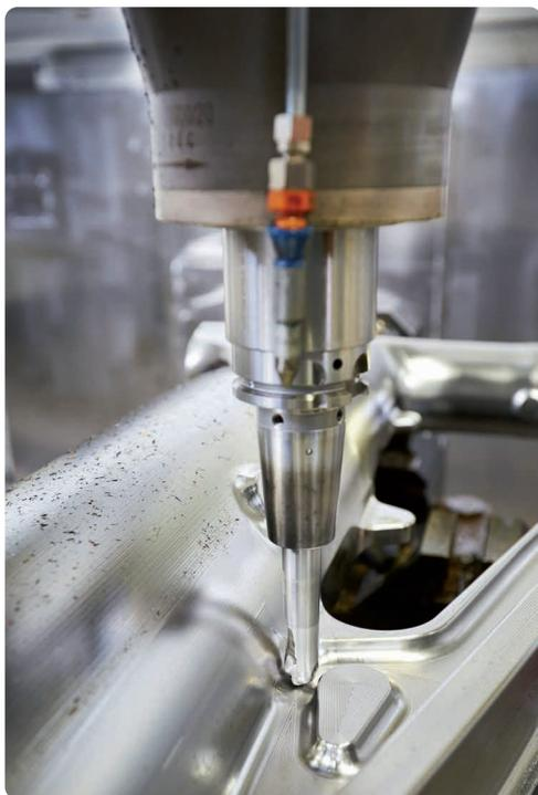
Bearbeitung eines Fahrwerkgehäuses (Foto: Liebherr-Aerospace Lindenberg)
