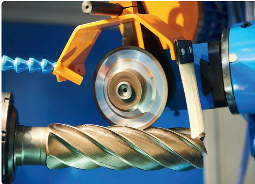
Typischer Scharfschleifprozess an Werkzeugen (Quelle: Pixel\_B / Fotolia 205728158)
