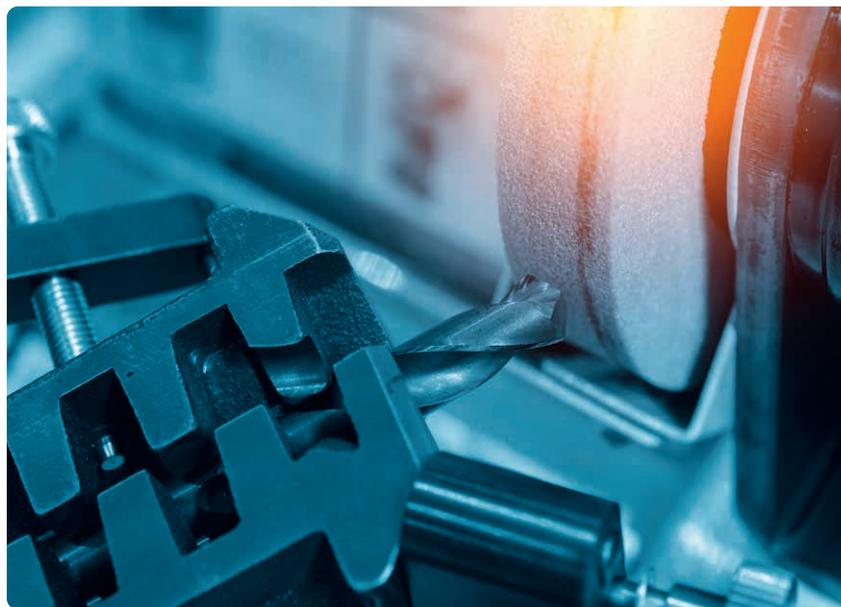
Typischer Scharfschleifprozess an Werkzeugen (Quelle: Pixel\_B / Fotolia 204459240)
