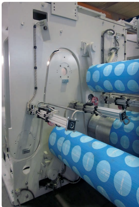
Die Abbildung zeigt unter anderem die im Abzugsständer (Pull-Roll) verbauter obere und untere Seitenplatte einer typischen Brückner-Anlage zur Herstellung von Kunststofffolien. (Foto: Brückner Maschinenbau)
