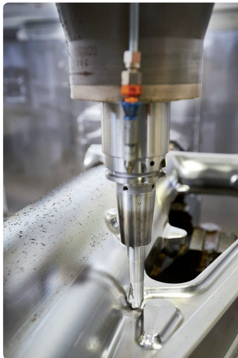
Bearbeitung eines Fahrwerkgehäuses (Foto: Liebherr-Aerospace Lindenberg)
