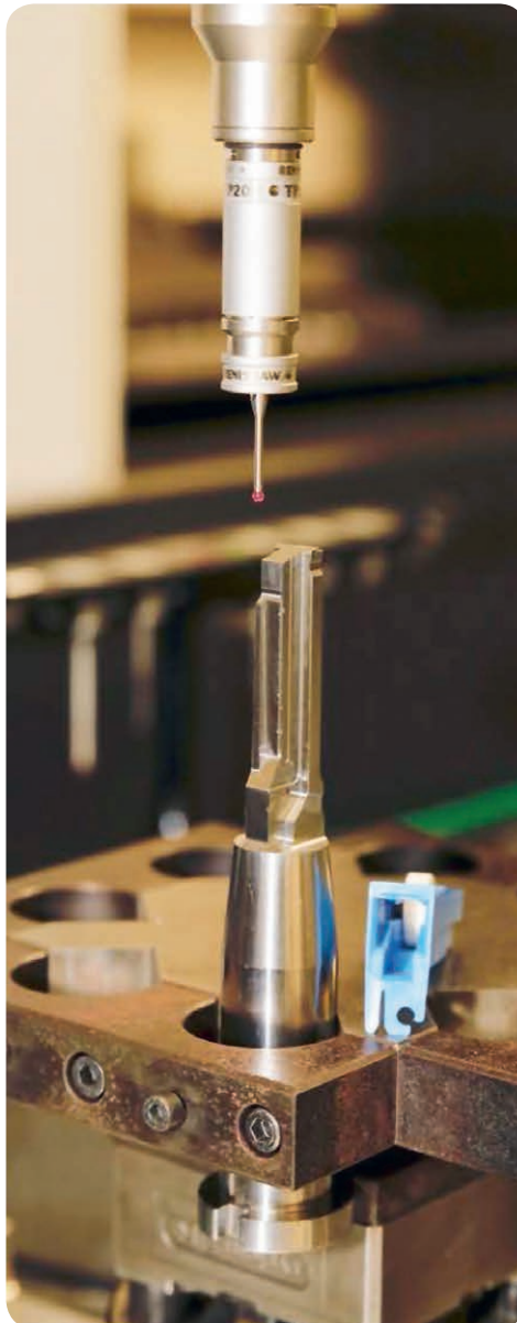
Filigrane Strukturen: Blick auf ein Endprodukt aus der Medizintechnik sowie auf den dazugehörigen Werkzeugstempel unter der Messmaschine
